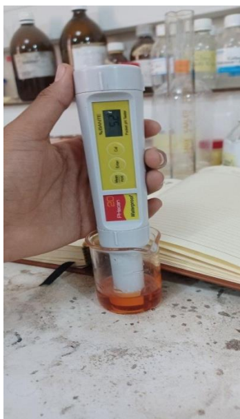
Figure 12 : Dispositif expérimental de mesure du potentiel hydrogène (pH) des extraits de Bougainvillea spectabilis à l'aide d'un pH-mètre digital.
