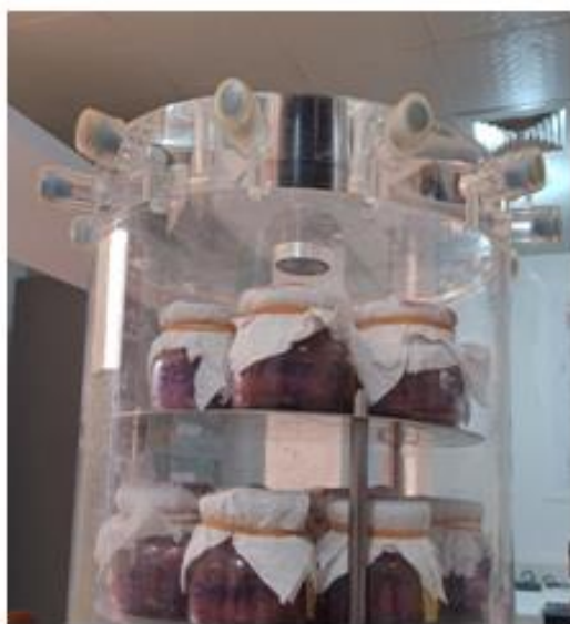
Figure 10 : Échantillons en cours de sublimation à l'intérieur de la chambre de lyophilisation du Christ Alpha 2-4 LSCbasic.
