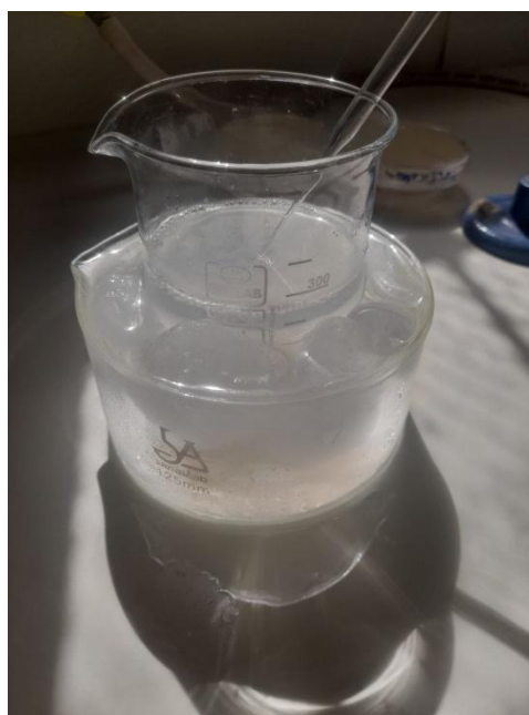
Figure 15 la précipitation de la chitine avec d'eau distillée glacée
