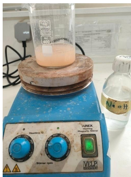
Figure 3 Processus de déprotéinisation des carapaces de crevettes par NaOH
