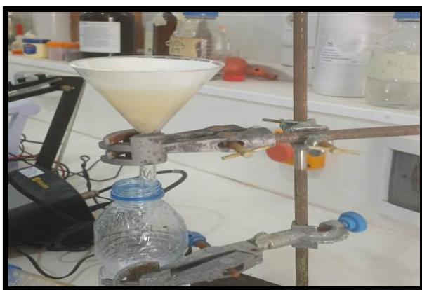
Fig.III.10. Filtration de l'extrait des plantes
