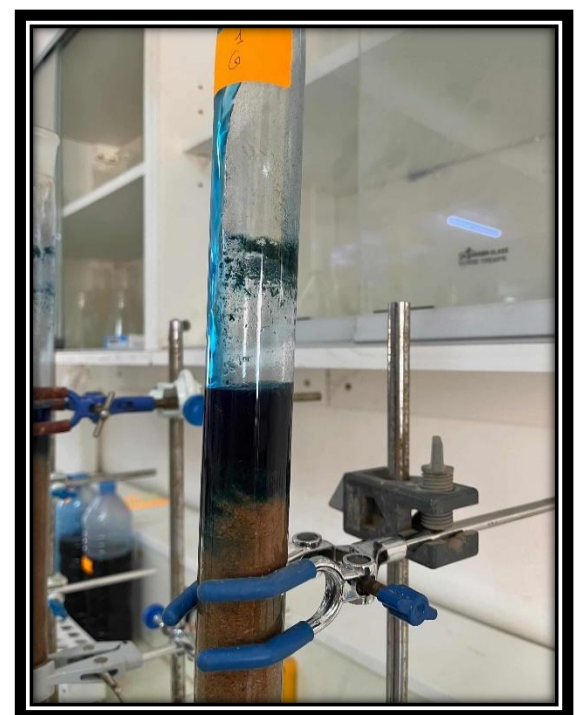
Image 6 : L'injection de Blue de méthylène dans la colonne par pissette
