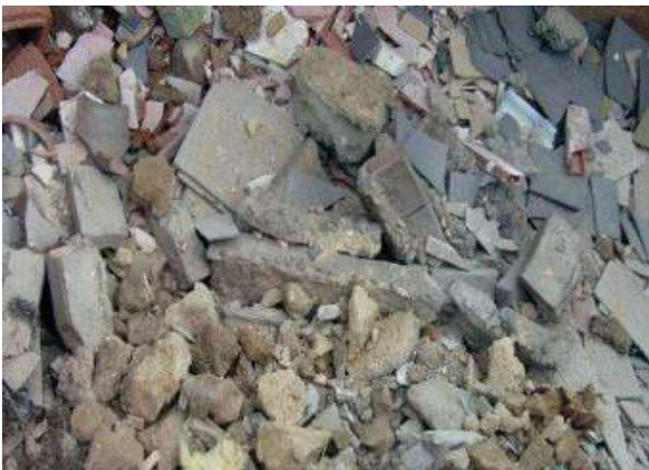
Figure 2 : Déblais de béton
