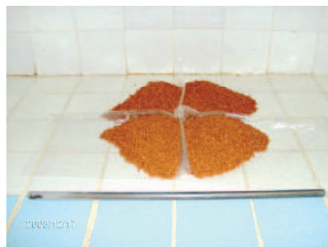
Photo A2-2 Réduction d'un Échantillon par Quartage
