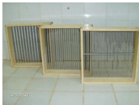
Photo A2-5 Grilles à Fentes Parallèles
