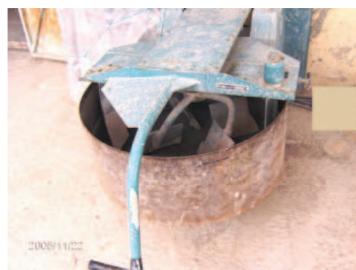
Photo A3-2 Malaxeur à Béton
