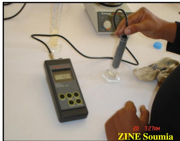
Photo 14. Le conductimètre
