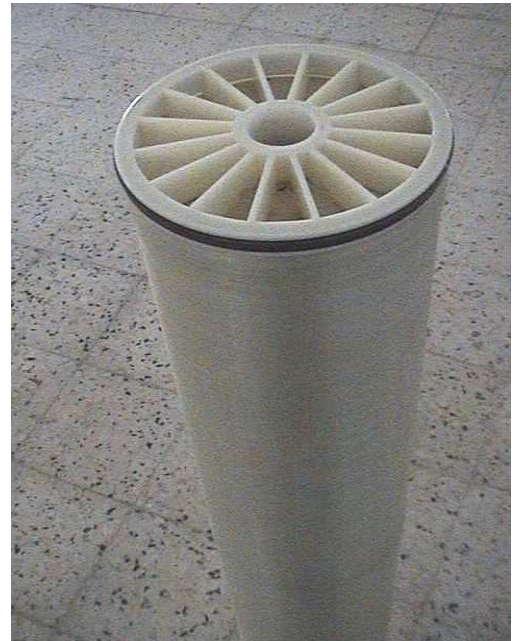
Photo 5 : La face externe des membranes d'osmose inverse
