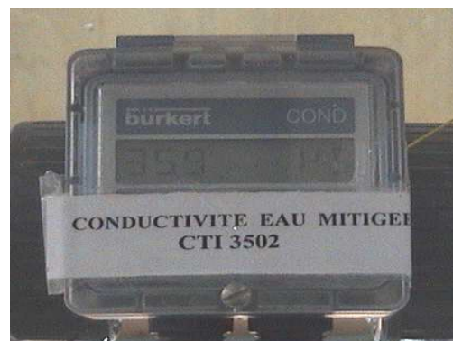
Photo 11 : Conductimètre installé dans le chaîne de traitement.
