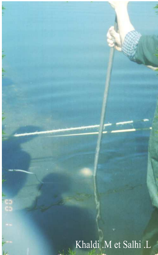
Figure N° (19): Schémas et photos de mesure de la vitesse des déifrent profondeurs
