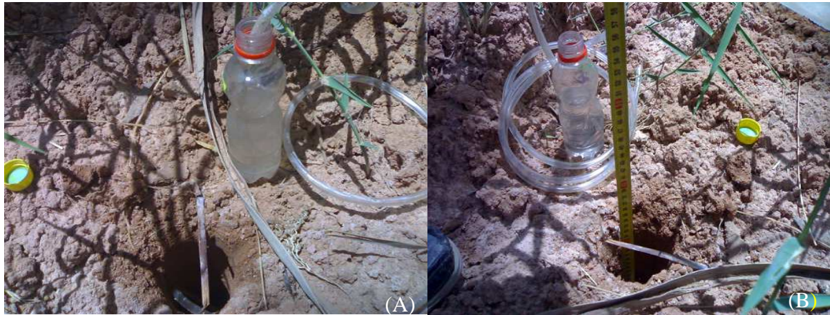
Photos 5. Prélèvement des échantillons des eaux et mesure du niveau de la nappe phréatique (A et B).
