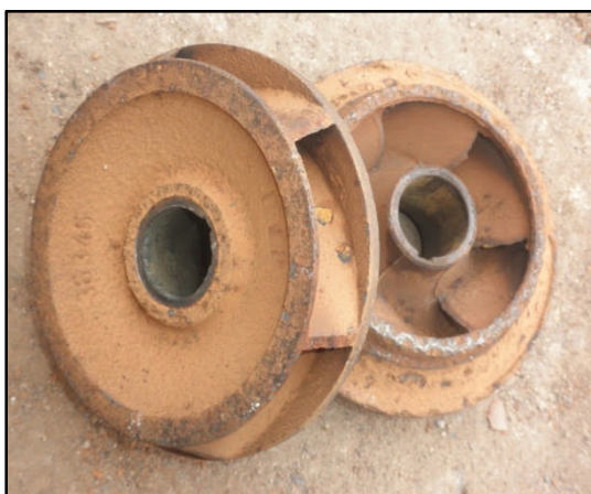
Figure IV.2.e : Roues fermées d'une pompe immergée endommagée par l'abrasion
