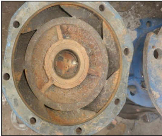
Figure IV.2.a : Corps de la pompe immergée endommagé par l'abrasion
