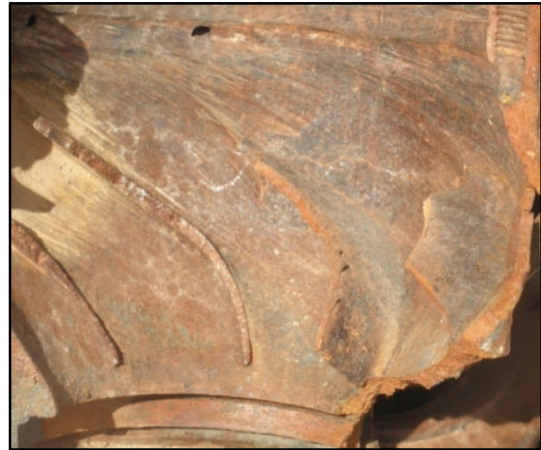
Figure IV.2.b : Corps de la pompe immergée endommagé par l'abrasion
