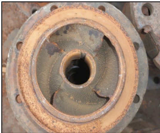
Figure IV.2.c : Roue fermée d'une pompe immergée endommagée par l'abrasion
