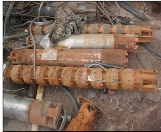
Figure IV.2.h : Différents pompes immergées endommagées par l'abrasion
