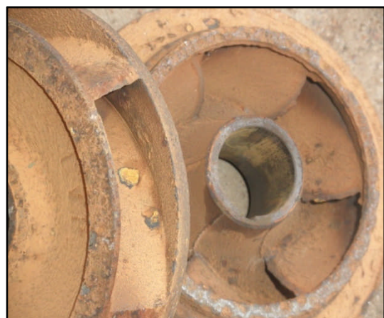
Figure IV.2.f : Roues fermées d'une pompe immergée endommagée par l'abrasion
