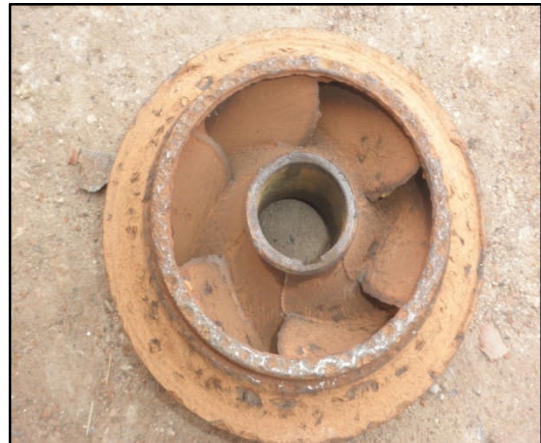
Figure IV.2.j : Roues fermées d'une pompe immergée endommagée par l'abrasion
