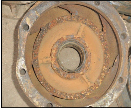
Figure IV.2.g : Corps de la pompe immergée endommagée par l'abrasion
