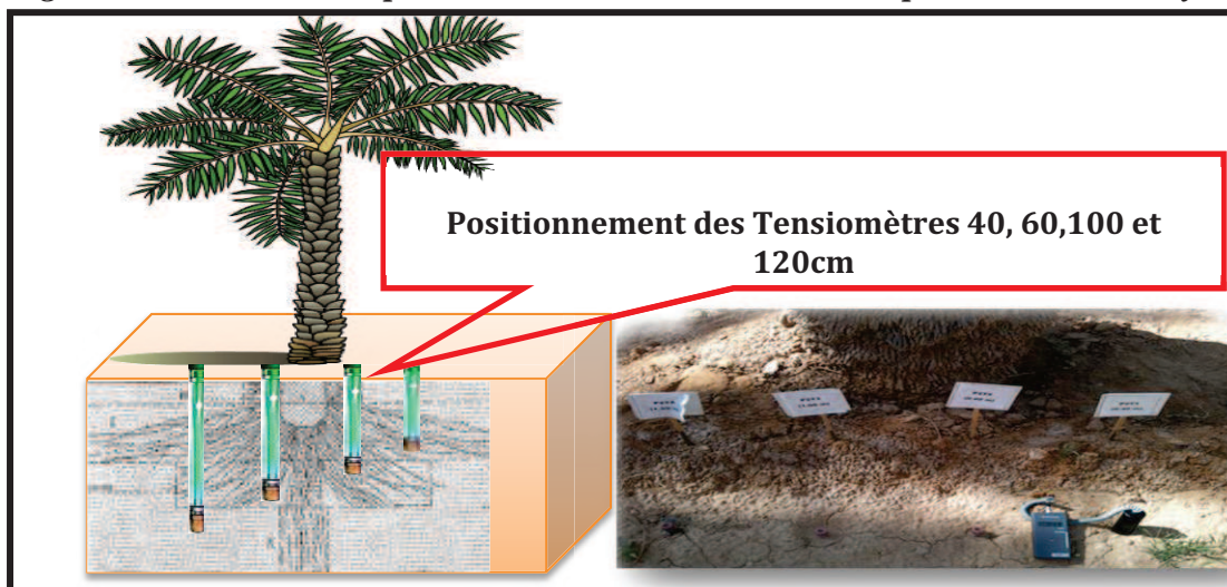
Figure N°09: Schéma du positionnement des tensiomètres et parcelle de Bilan hydrique.
