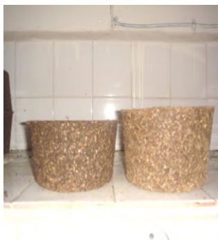
Photo (10) : Démoulage et séchage des blocs
