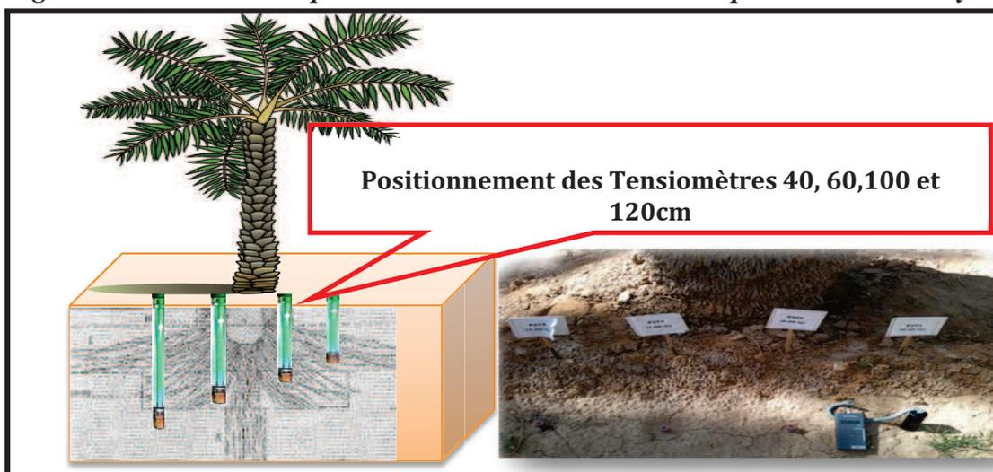
Figure N°10: Schéma du positionnement des tensiomètres au-dessous le palmier.
