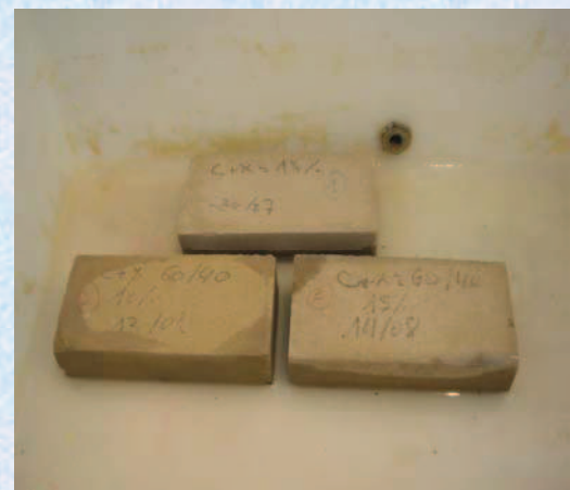
Photo A11 : Essais absorption d'eau par capillarité
