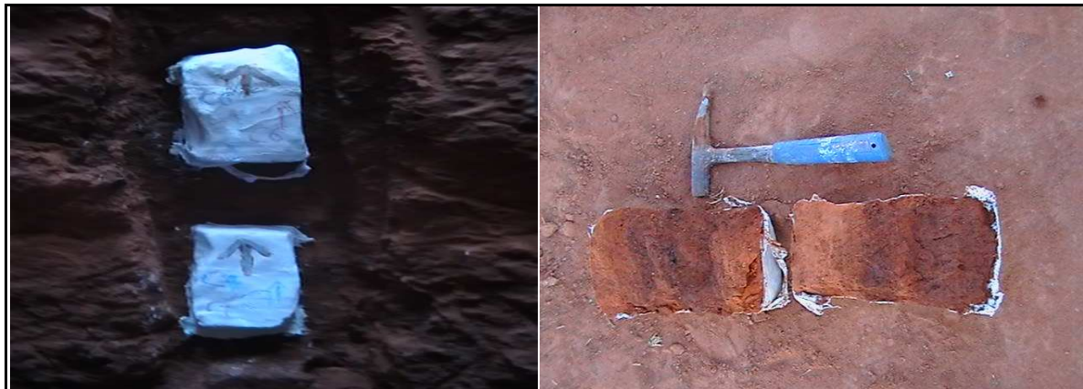
Photo III.04: Echantillons non perturbés et orientés pour la fabrication de lames minces
