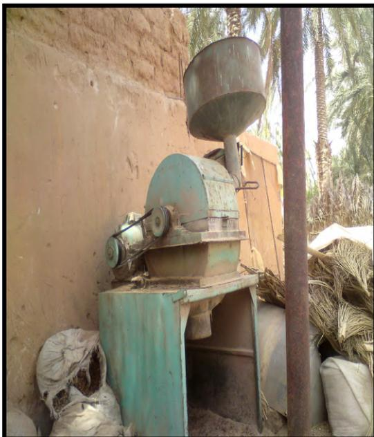
**Photo 22 : Broyeur d'aliments concentrés**
