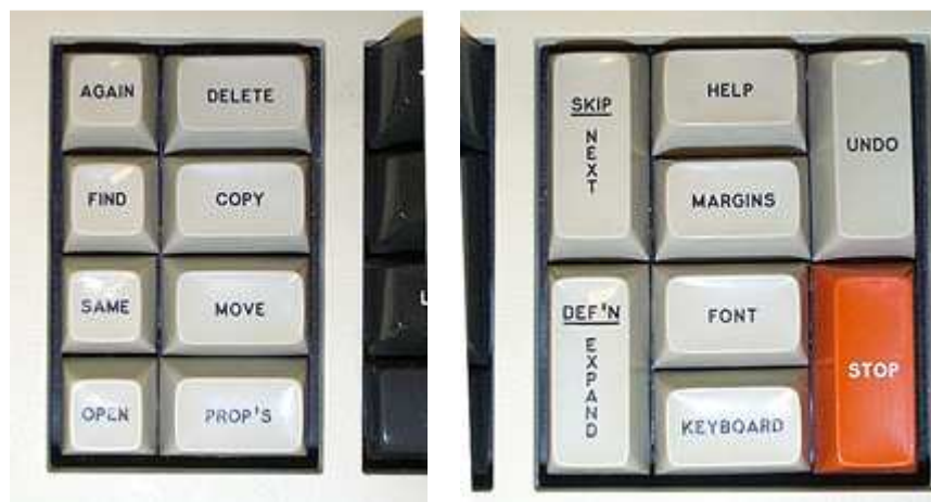
Figure III.5: Le clavier du Star, pavés de touches de fonctions disposés de part et d'autre du clavier alphabétique.
