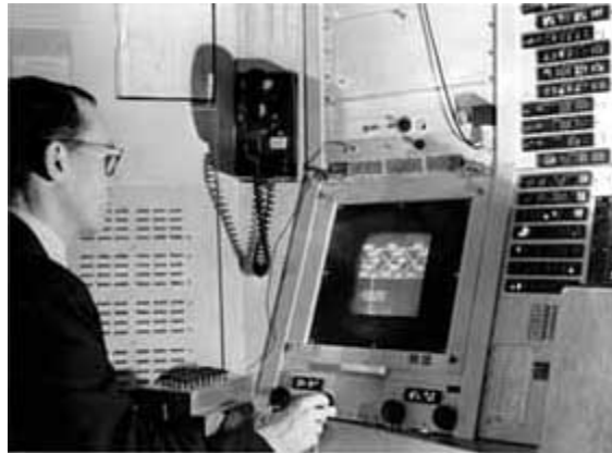
Figure III.1: Ivan Sutherland à la console du TX-2, travaillant sur SketchPad (MIT).
