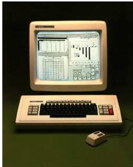
Figure III.3: L'écran, le clavier et la souris du Xerox 8010, connu sous le nom de Star.
