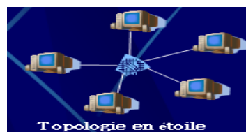
Figure 1.3: Topologie en étoile
