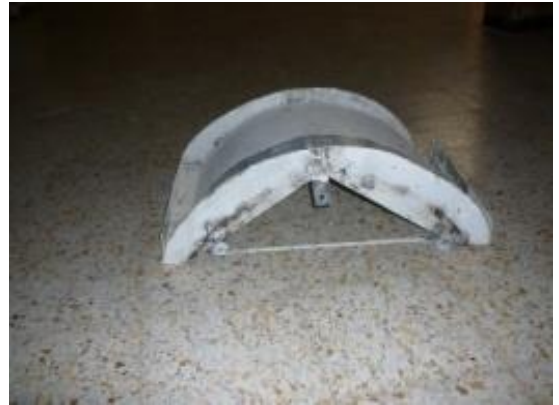
الصورة (III.15): إستعمال لبئات جبسية للسقف والجدران بمدينة سيدي خويلد - ورقلة -
