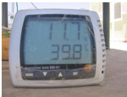
*Figure (II-5): hygromètre Testo 608-H1*
