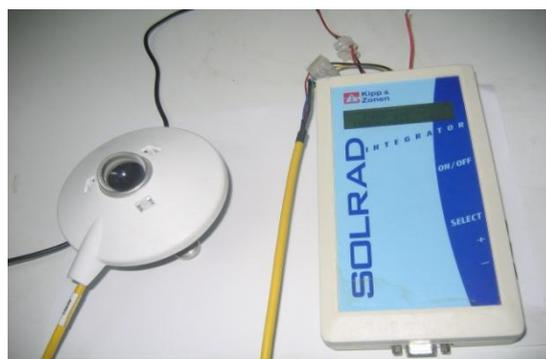
*Figure (II-3) : Solarimètre à affichage numérique*
