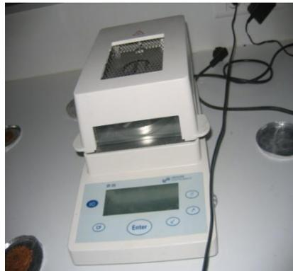
*Figure III.1: Analyseur d'humidité SARTORIUS MA*
