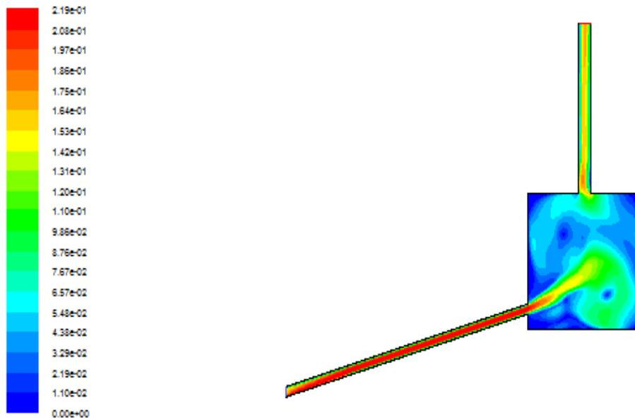
*Figure IV-2: la Distribution de vitesse dans le Séchoir N° I*
