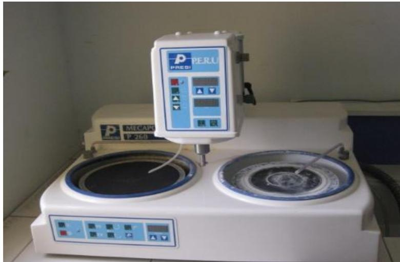
**Figure (II-3): Polisseuse de type Presi Mecapol P 260**
