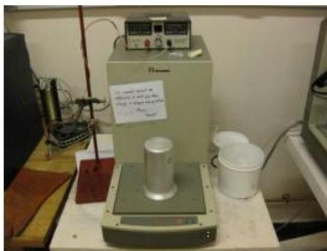
**Figure (II-7): Calorimétrie Différentielle à Balayage DSC TA instruments**
