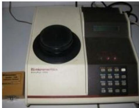
**Figure (II-10): Pycnomètre à hélium micromeritics Accupyc 1330**
