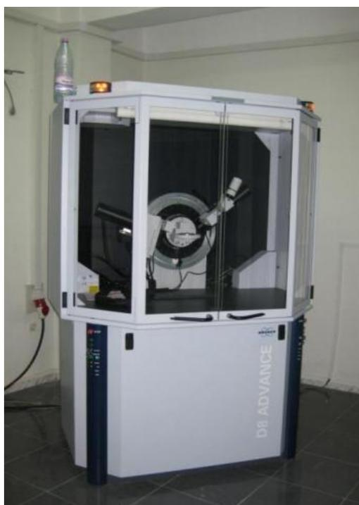
**Figure (II-5): Diffractomètre à rayons X de type Bruker D8 ADVANCE**
