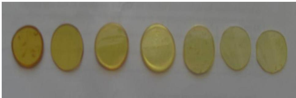
**Figure (III-2): Echantillons de verres dans le système ternaire  $(80-x)\text{Sb}_2\text{O}_3$ - $20\text{Li}_2\text{O}$ - $x\text{WO}_3$**
