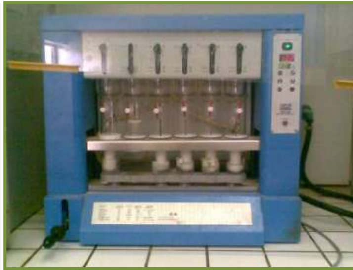
Figure N°10 : l'extracteur Soxhlet (148series 6/6).
