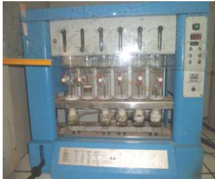
Photo 1 : l'appareille de l'extraction d'huile alimentaire (Soxhlet)
