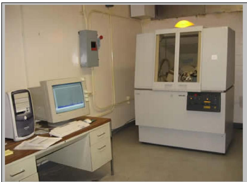
Photo .3.1: diffractomètre des Rayons X sur poudre (Philips X'Pert-MPD X-ray Diffraction System)
