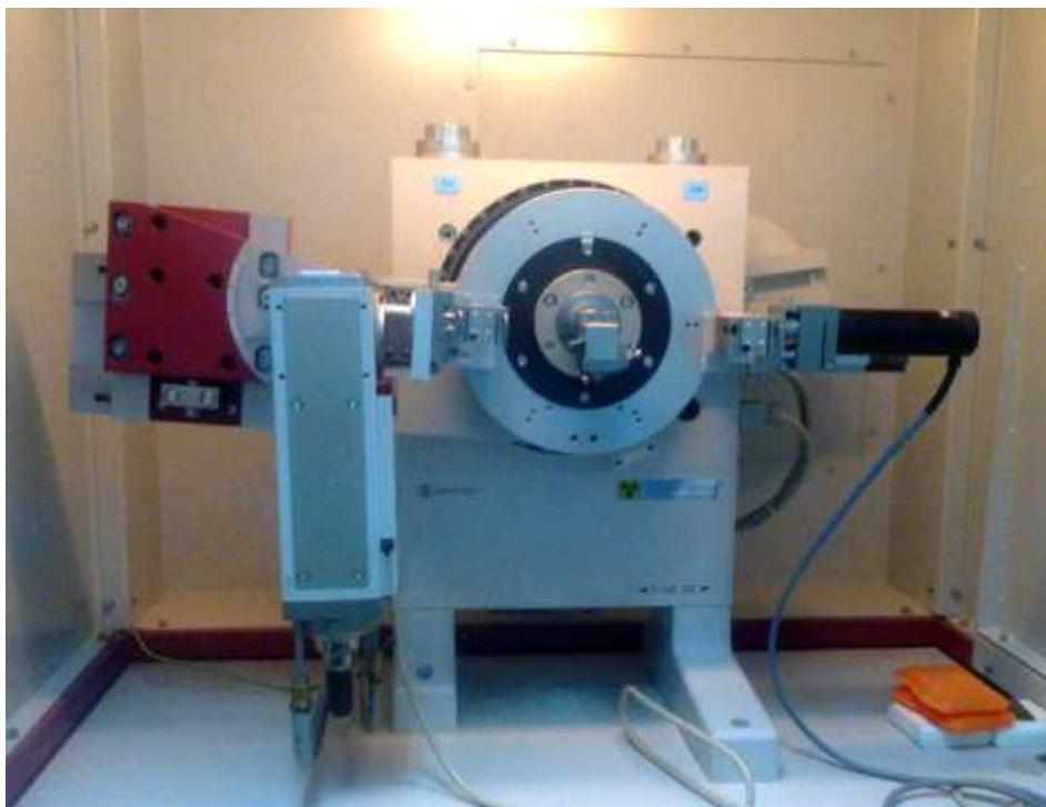
Figur- IV-10 : un diffractomètre de la marque SEIFERT type XRD 3003T-T
