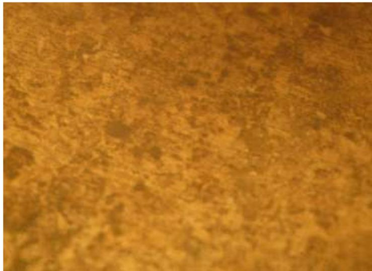
Figure- IV-2: L'état morphologique d'un échantillon revêtu avec quatre couches avant traitement thermique.
