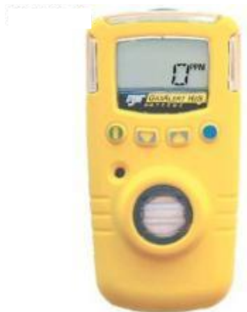
Figure : III-1 Détecteur de gaz h 2 s portable, 500ppm, affichage des valeurs
