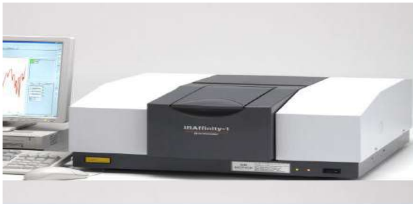
الشكل(III-5) جهاز مطياف الأشعة تحت الحمراء
