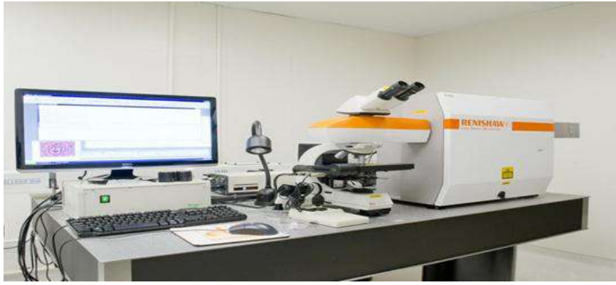
الشكل (III- 8) جهاز المستعمل في مطياف رامان
