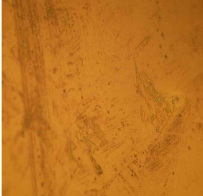
الشكل (4-19): الملاحظة المجهرية لعينة مرسبة و غير معالجة حراريا (4 مرات غمر)
