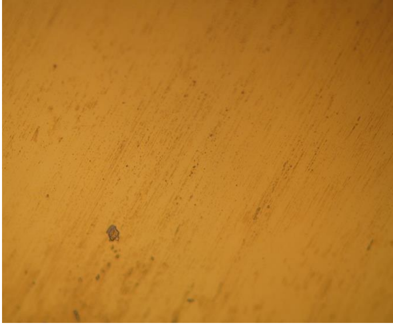
الشكل(4-20) : الملاحظة المجهرية لعينة مرسبة و المعالجة حراريا عند درجة 300^{\circ}\text{C} (4 مرات غمر)
