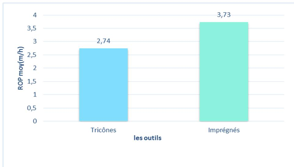
Fig.IV.01 : Variation des ROP moy (m/h) des outils tricône et imprégné dans la cambrien Ra
