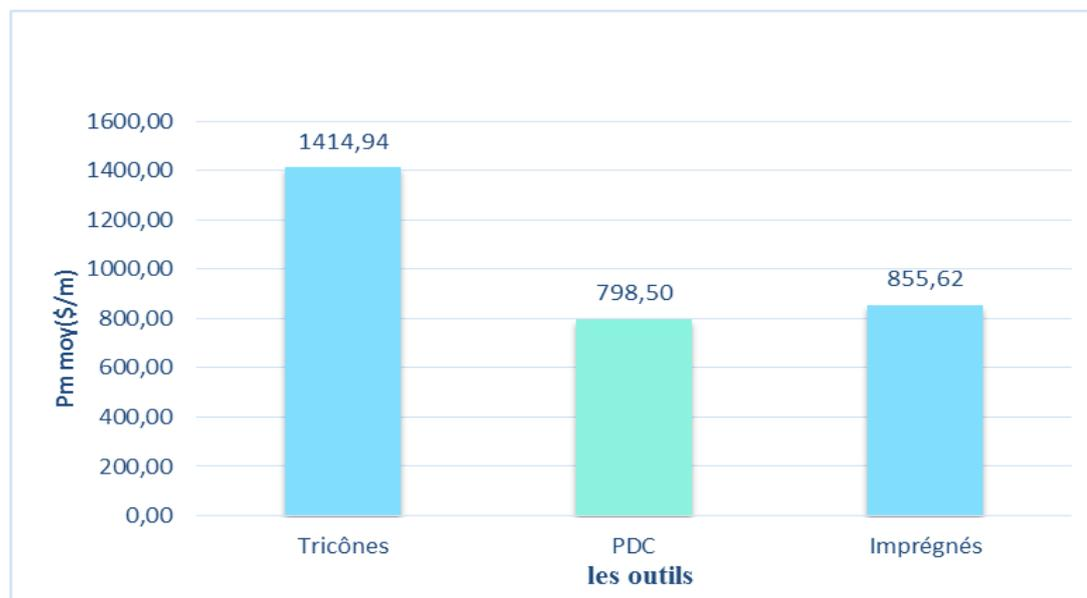
**Fig.IV.04 : Variation de Pm<sub>moy</sub> entre les outils tricônes, PDC et imprégnés dans la cambrien R<sub>2</sub>**
