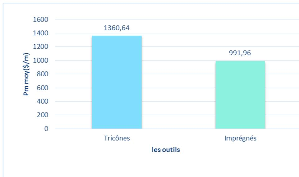
Fig.IV.02 : Variation de Pm moy (\$/m) entre les outils tricône et imprégné dans la cambrien Ra
