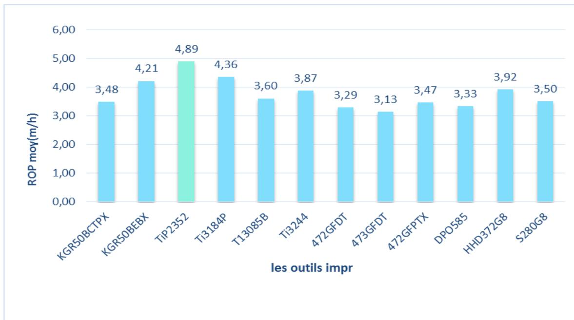
**Fig.IV.05** : Variation de ROP moy entre les outils imprégnés utilisé dans la cambrien Ra
