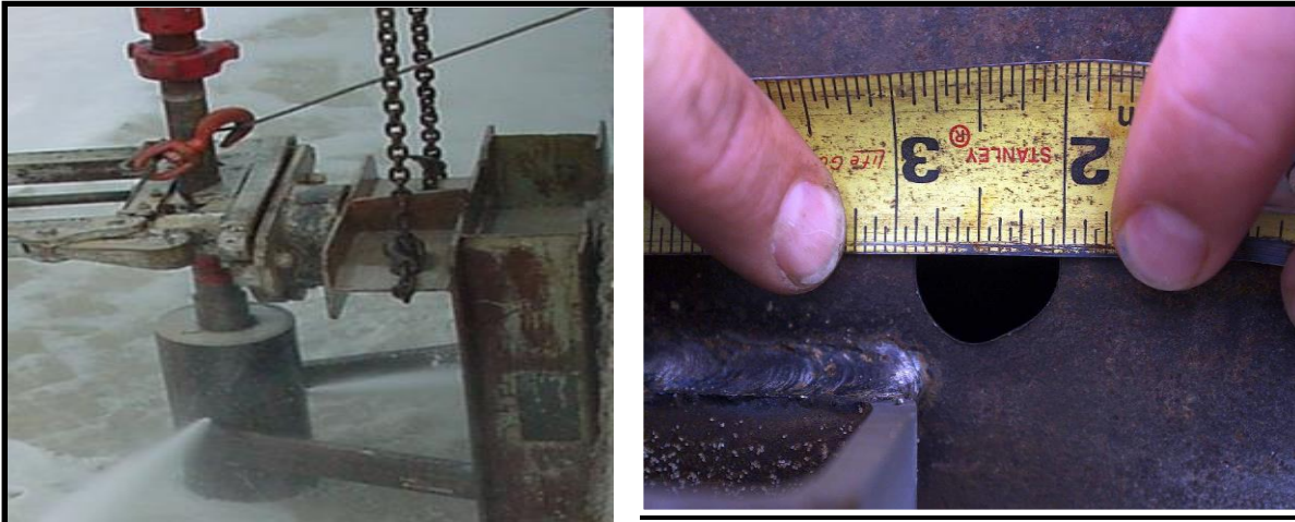
Fig.15 : Les essais de l'opération surgi-jet à la surface
