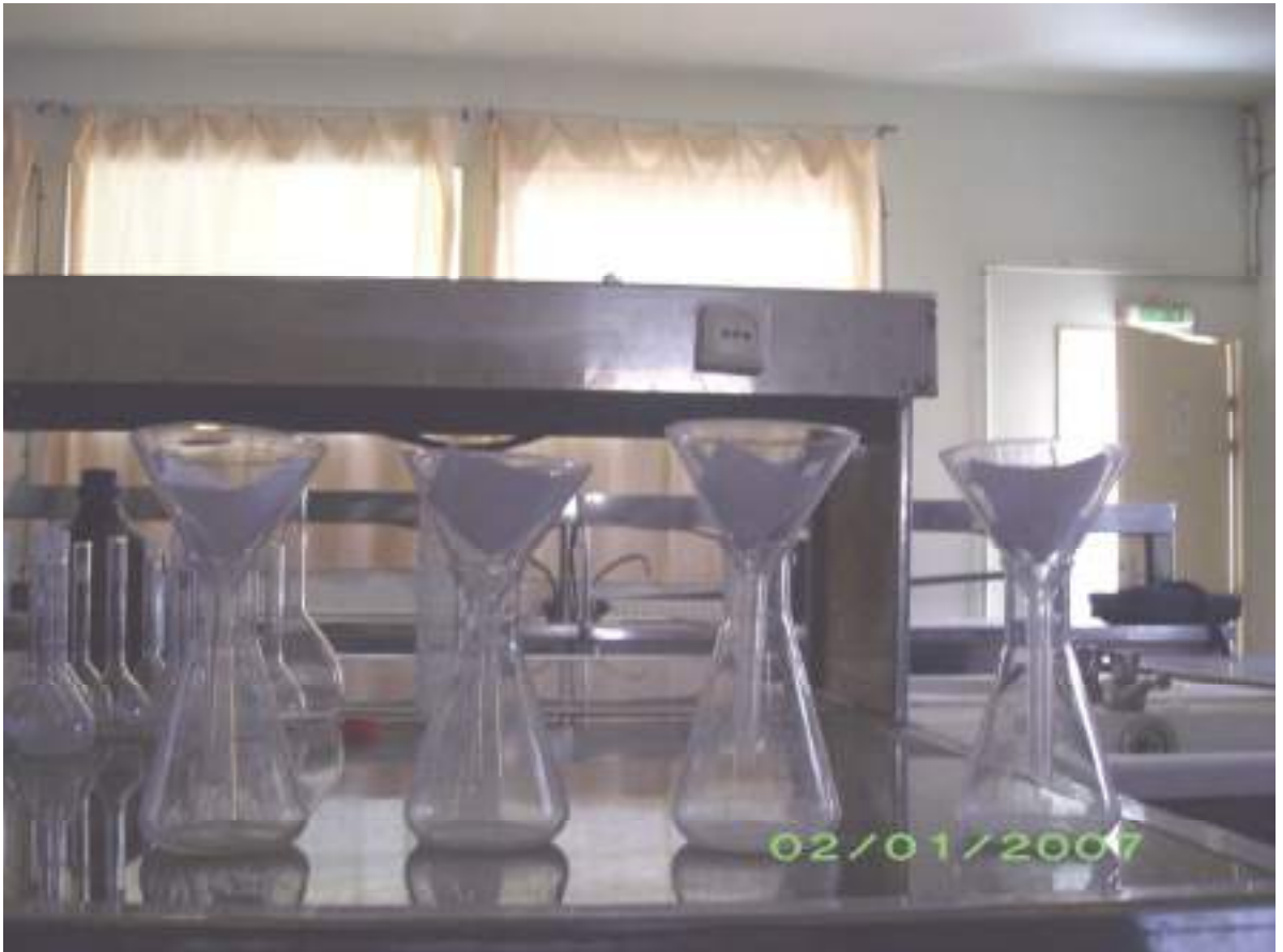
Fig27 : les appareils utilisés pour la détermination de MES. [14]
