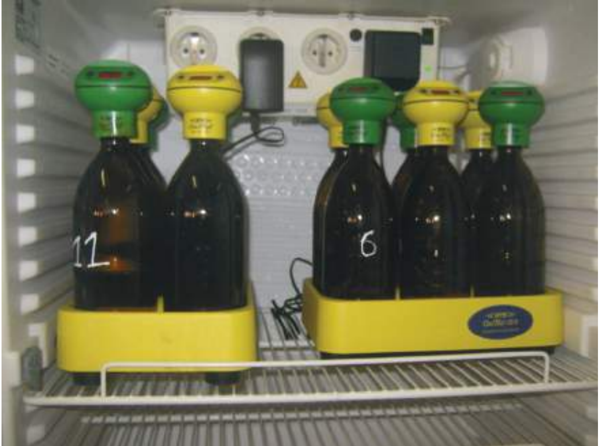
Fig30 : DBO mètre pour la détermination de DBO5. [14]
