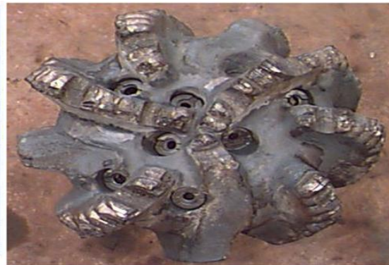
Endommagement par de la ferraille
