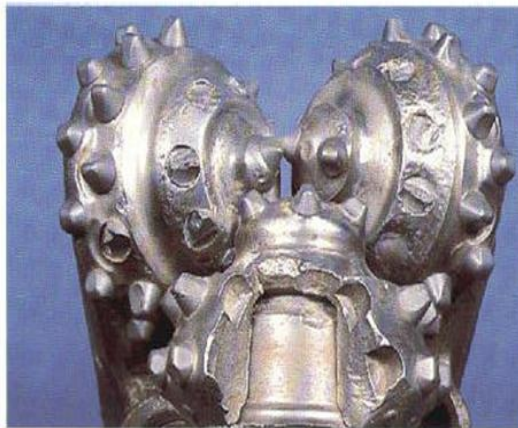
Rupture de cône
