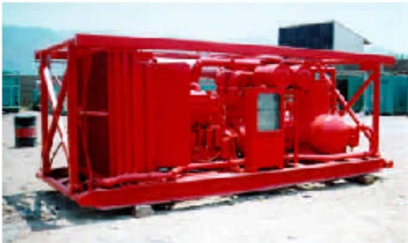
**Fig II.10 : Compresseur d'air**
