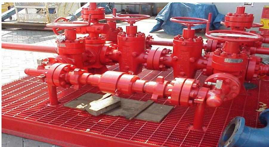
**Fig.II.15 : Manifold de L' underbalance**
