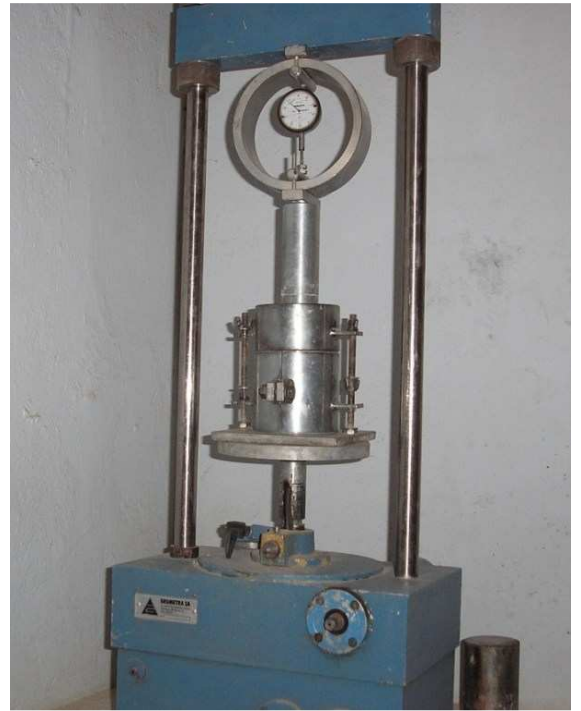
Photo 4: Presse utilisée pour compactage
