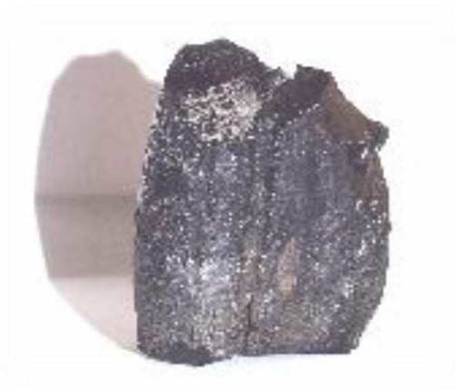
Figure. II.1. Schéma d'un dépôt d'asphaltènes (source : Etude de la stabilité des asphaltènes dans le pétrole brut)
