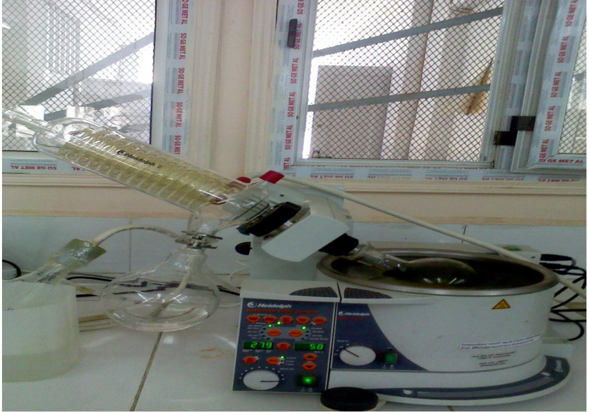
الشكل (3-IV): جهاز التبخير الدوراني Rotavabeur
