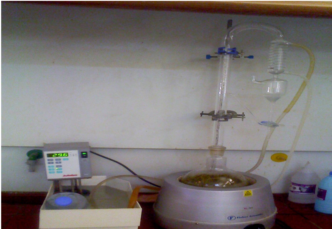
الشكل (1-IV): تركيب التقطير المائي بجهاز Clevenger
