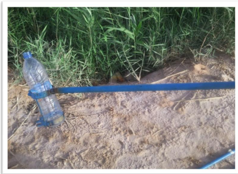
photo.III.02.l'outil de prélèvementavec une bouteille
