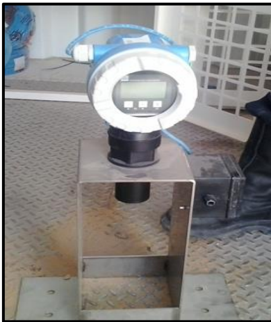
Figure 10: Capteurs de niveaux de bac
