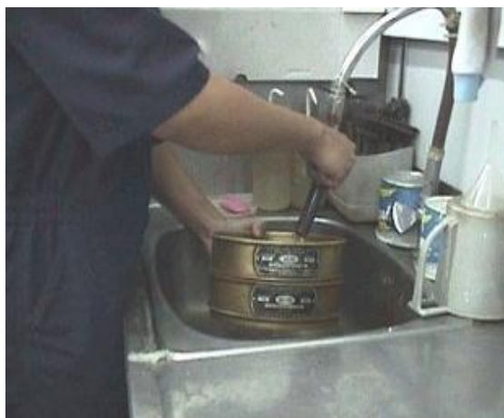
Fig.12 : lavage et tamisage des cuttings.
