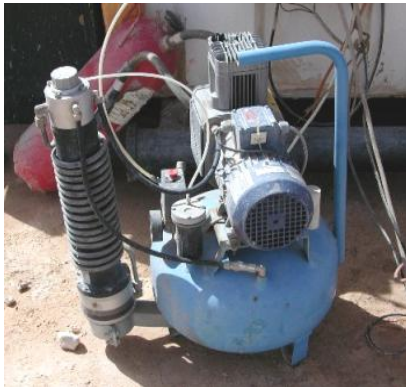
Figure.13: Compresseur à air
