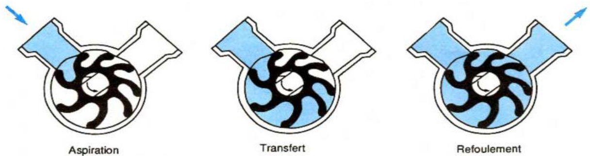
Figure (I.9) : Pompes à palettes flexibles
