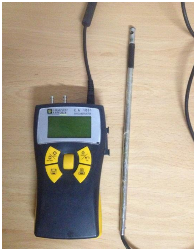
Figure (III-12): Anémomètre à fil chaud.
