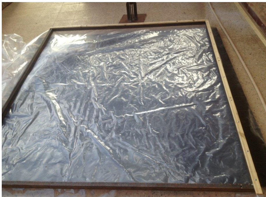
Figure (III-9): Bâche fixée sur le cadre métallique
