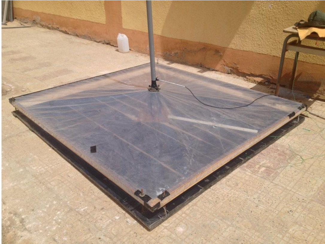
Figure (III-10): Prototype Cheminée Solaire
