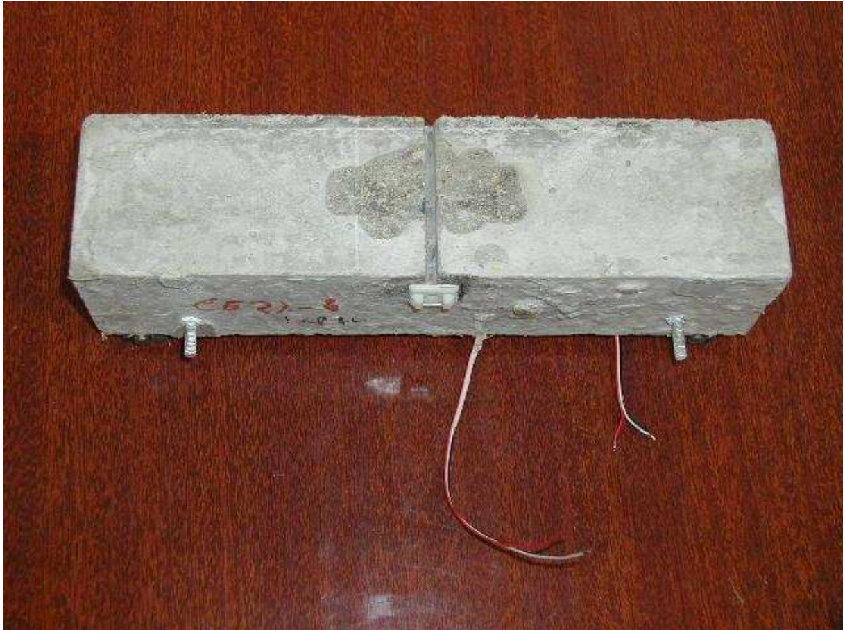
Photo3 : La réalisation d'une rainure au milieu des éprouvettes.
