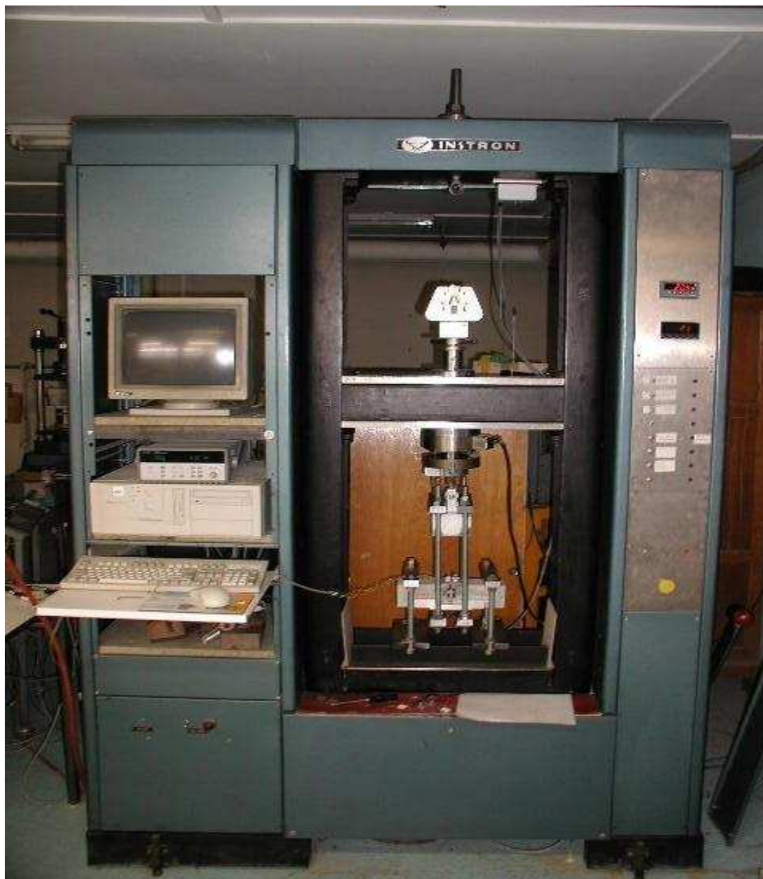
Photo1: Presse universelle «INSTRON» utilisée pour l'essai de flexion sur béton.
