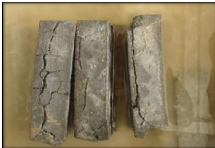
Figure(II.18) : Gonflement et éclatement des éprouvettes.
