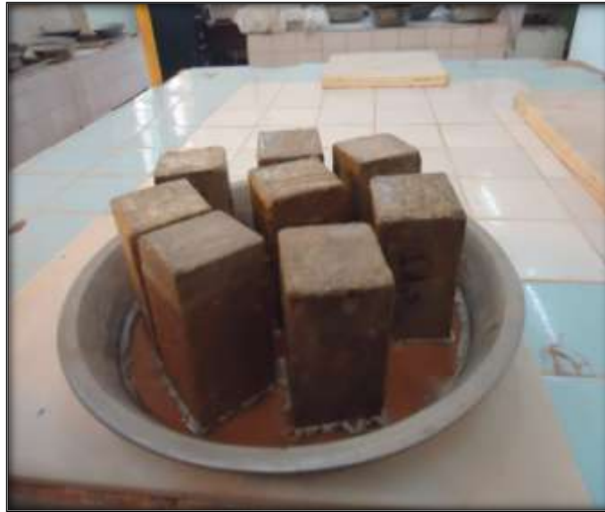
Figure (II. 17): Essai d'absorption capillaire d'eau
