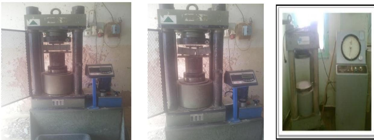
Photo(II-7) : machine d'essai à la compression et Traction.
