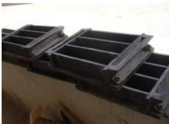
Photos (II-3): moules prismatiques d'éprouvettes.
