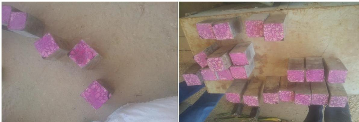
Photo(II-6): résultat d'essai de carbonatation.
