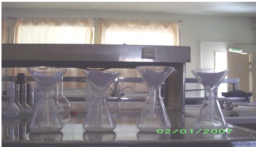
Photo 05: Filtration pour la détermination de MES.
