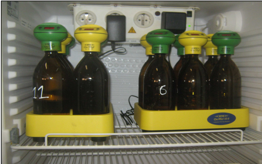
Photo 04: La DBO mètre pour la détermination de la DBO.
