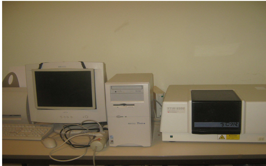
Photo 12: Le spectrophotomètre FTIR.
