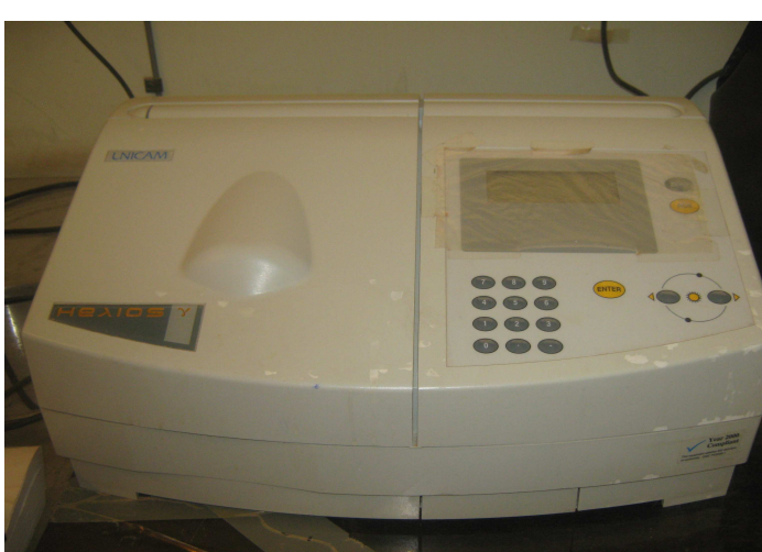
Photo 10: Le spectrophotomètre UV-visible.
