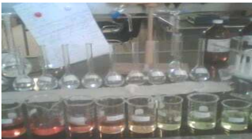
Photo 07: Les solutions étalons de dosage colorimétrique (indice de phénol) par la méthode de 4-Aminoantipyrine.
