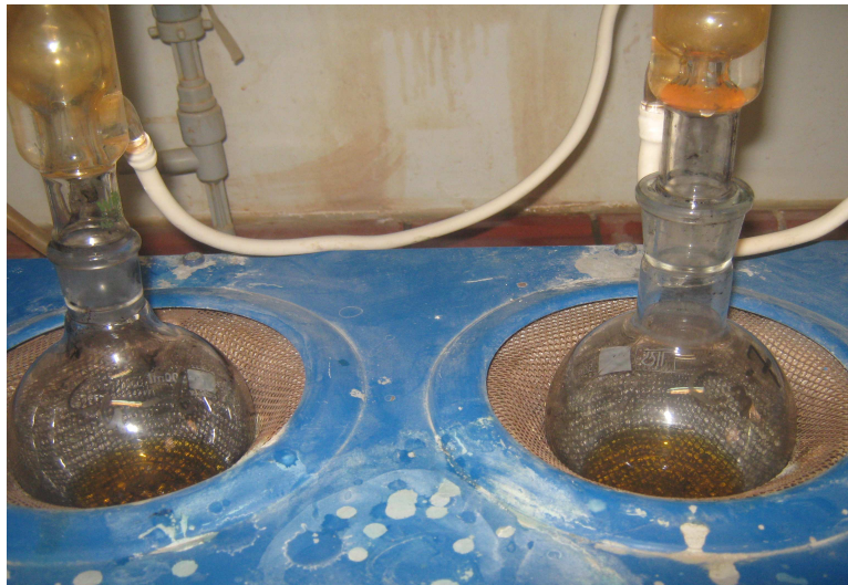
Photo 02: Montage à reflux pour la détermination de la DCO.
