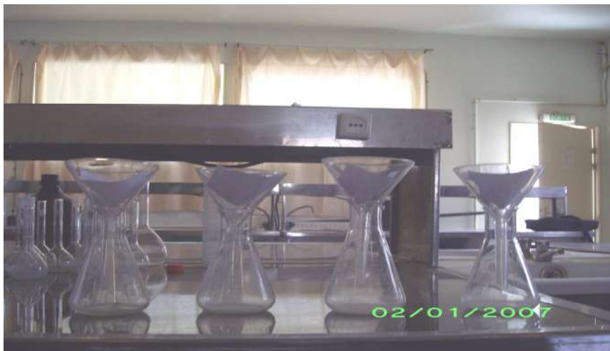
Photo 05: Filtration pour la détermination de MES.
