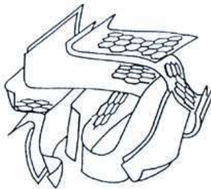
Figure (44): Représentation schématique des microstructures du charbon actif [5,59].
