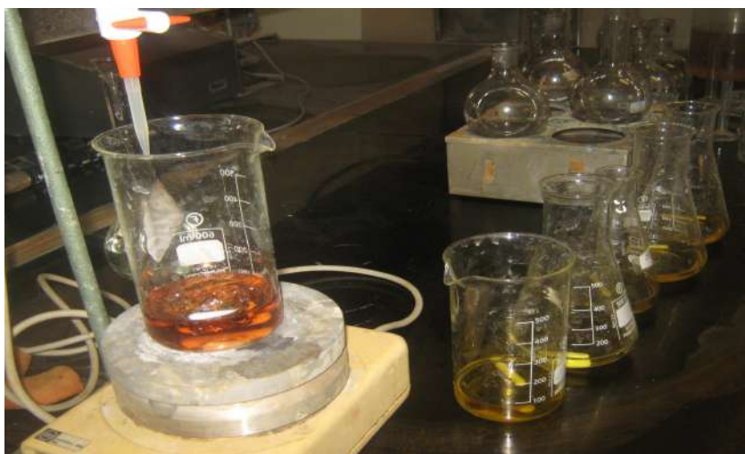
Photo 03: Titrage pour la détermination de la DCO.
