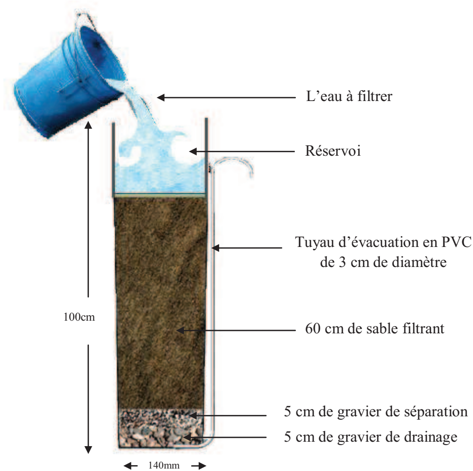
Figure 10 : coupe du filtre à sable utilisé.
