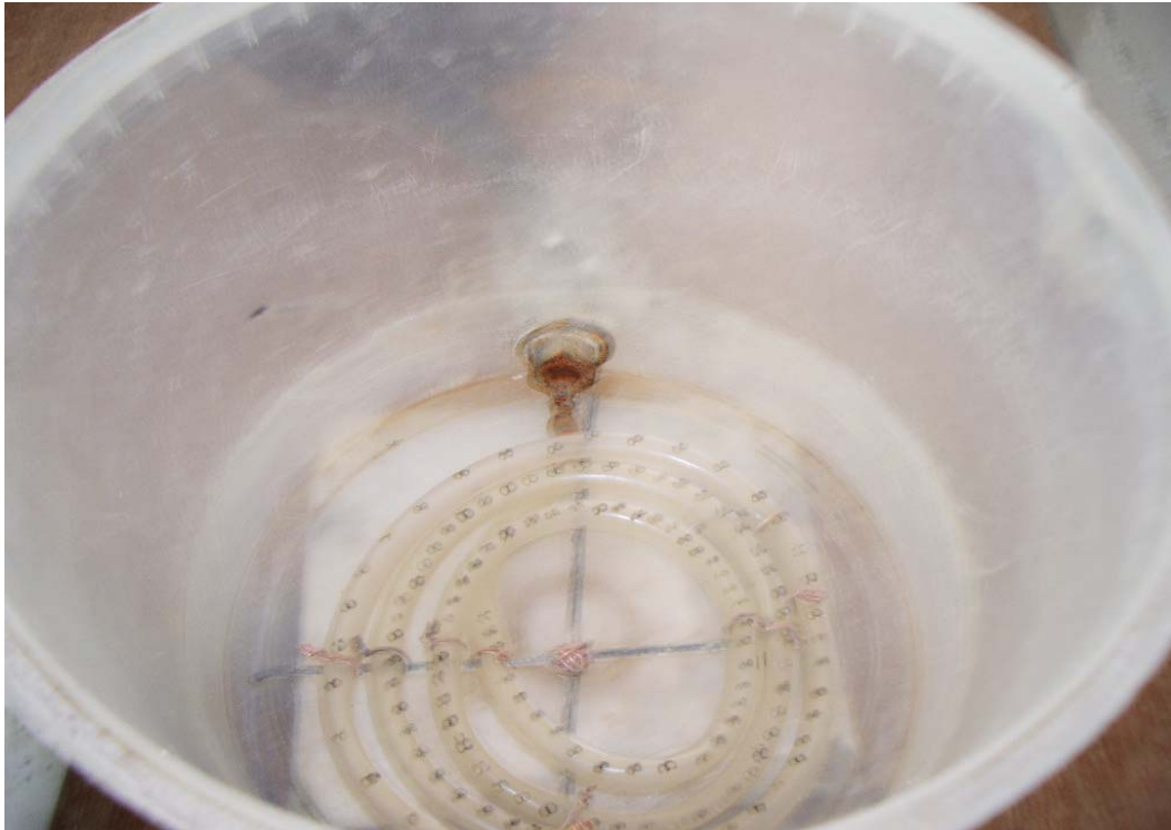
Figure II.4. Vue intérieure de l'évaporateur
