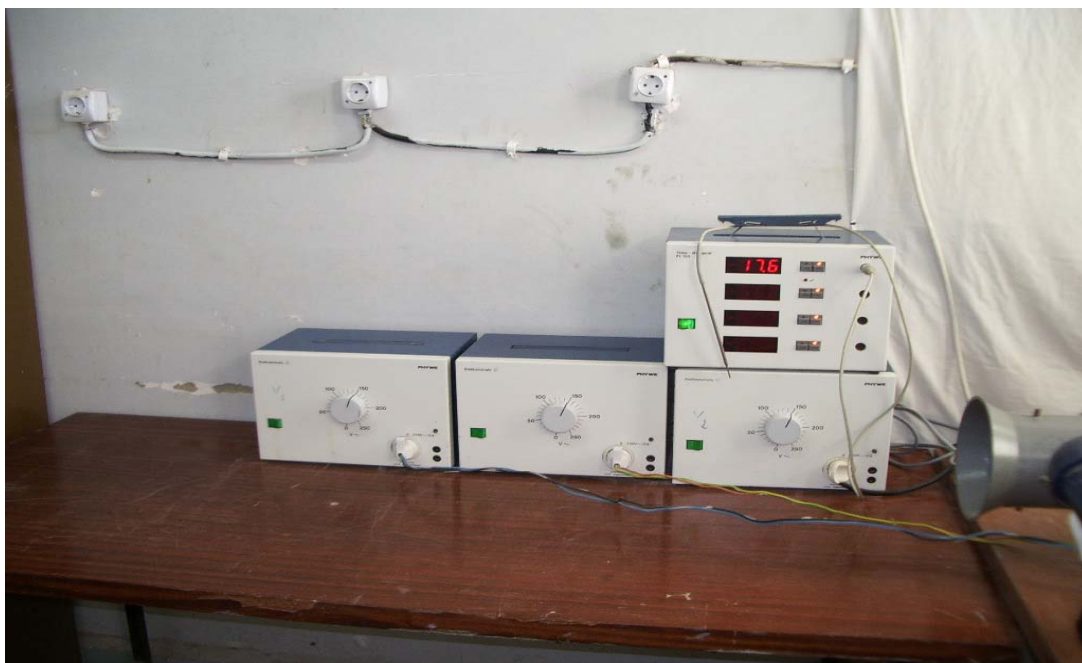
Figure II.3. Les générateurs de tension et afficheur de la température
